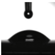
Superficie non trattata Idrorepellente
